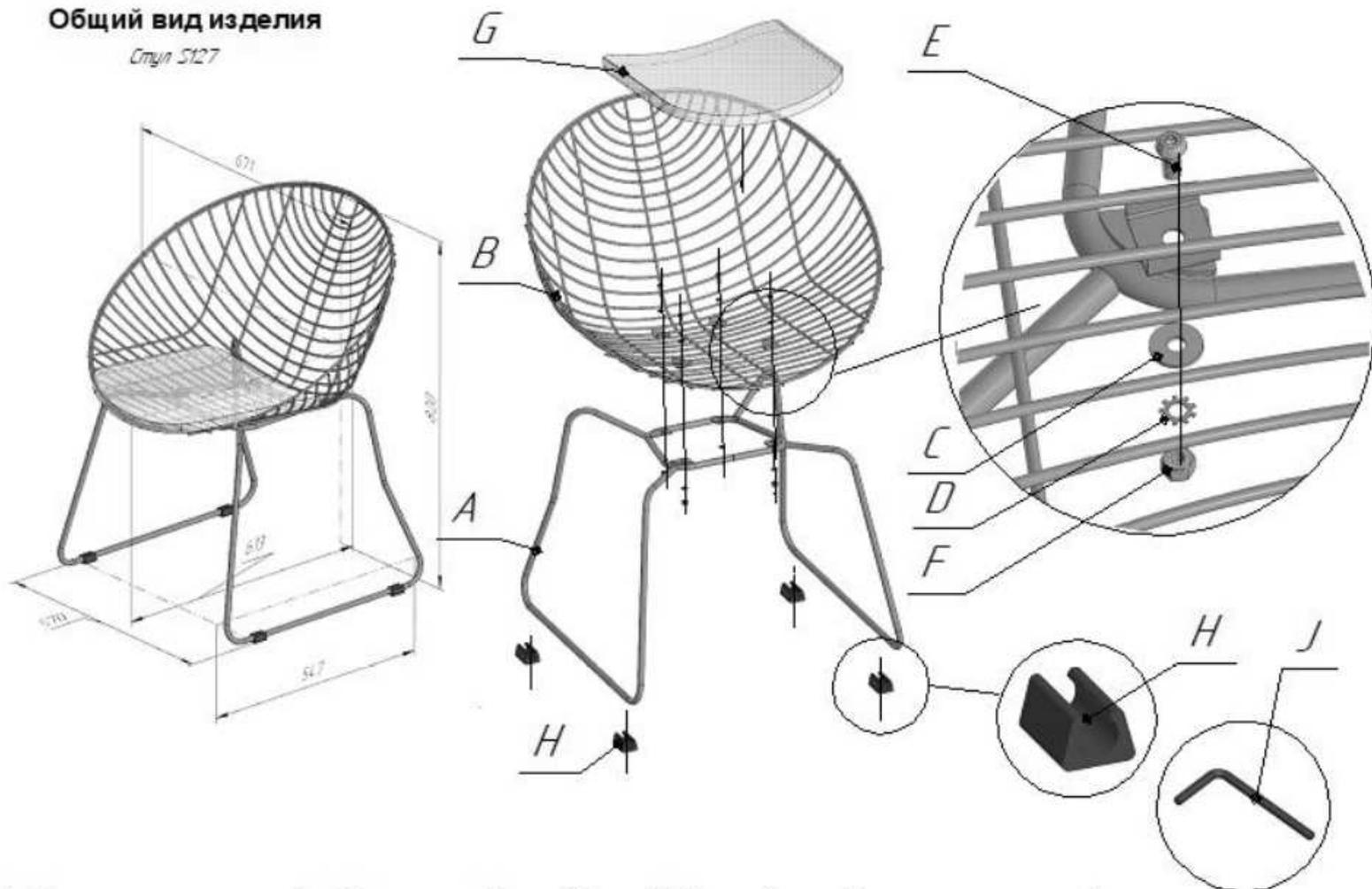
1. Соединить каркасы А и В, винтами Е, шайбами С, D и гайками F, используя ключ J.
